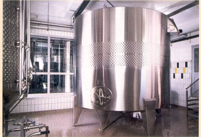
Abb. 3 Die spiegelglatte Innenoberfläche des Weißbier-Gärtanks lässt sich mit einfachen CIP-Kugeln reinigen
