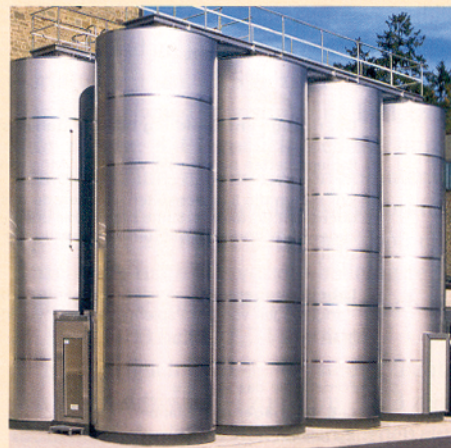
Abb. 1 Außenansicht der ZKG-Tanks mit zentralem Bediengang und dicht verschweißter Edelstahl-Isolierverkleidung
