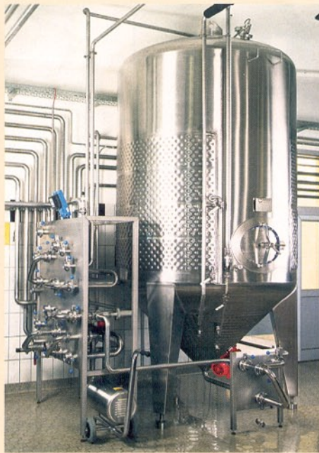
Abb. 4 Hefepropagator mit Steril-Magnetrührwerk
